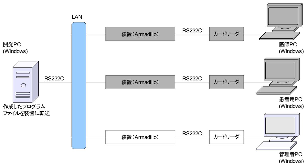
装置 (Armadillo): データベースを搭載した制御装置で、カードの R/W、および業務 PC の入出力制御を行う
